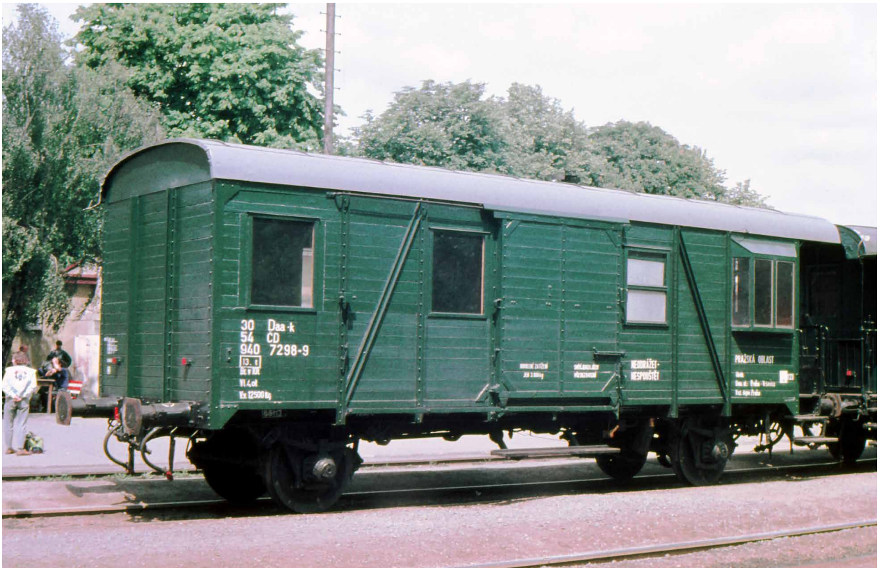
Obr. 15. Služební vůz řady Ds vyrobený v českolipské vagónce, zachycený na nádraží Praha – Braník v roce 1994 (foto Ivo Mahel).
