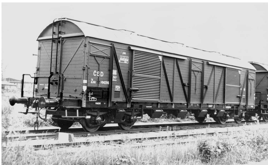
Obr. 3. Čtyřnápravový nákladní zavřený vůz řady Zsa (fotoarchiv firmy ALSTOM Czechia a. s., Česká Lípa).
