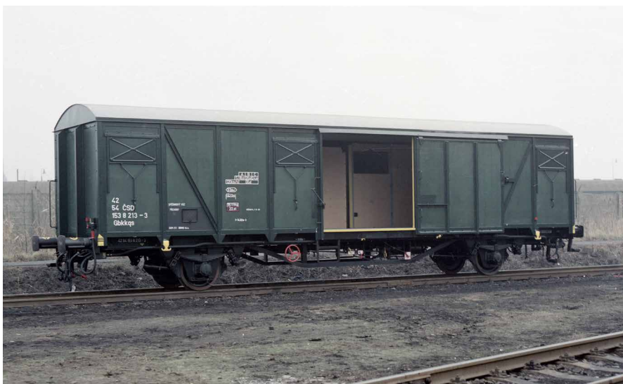
Obr. 4. Dvounápravový nákladní vůz řady Gbgkks/Zts z 80. let 20. století (fotoarchiv firmy ALSTOM Czechia a. s., Česká Lípa).
